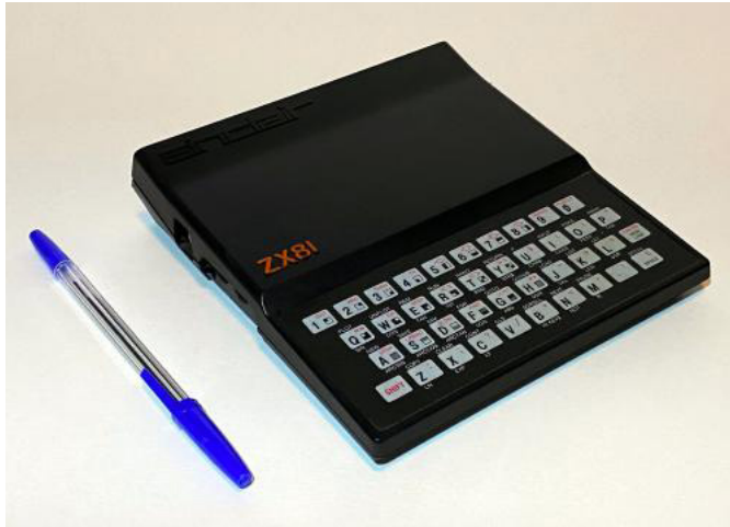
Fig. 2. Le ZX81 (stylo bille pour l'échelle), avec ses trois connecteurs pour la télévision, le lecteur de cassette et l'adaptateur secteur
