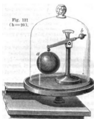
4. Le premier schéma du baroscope statique de Robert Boyle
