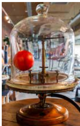
5. Le baroscope statique de l'XP sous vide
