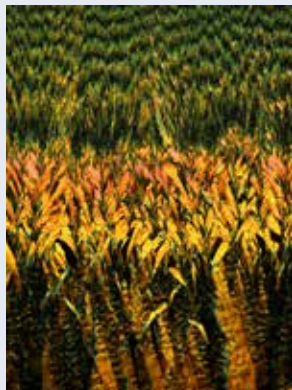
Photo prise sous microscope à lumière polarisée de domaines cristallins du semi-conducteur organique 2,5-bis(3-dodecylthiophene-2-yl)thiazolo[5,4-d]thiazole alignés selon un axe préférentiel sous polariseurs croisés (10X)
