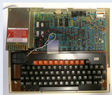
Le processeur 6502 du BBC computer modèle B+. Il s'agit en fait d'un 6512 produit par la firme Rockwell, sous licence de MOS. Il remplace exactement le 6502.
