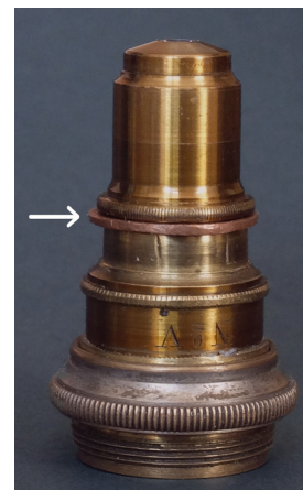
Fig 10. Position de la bague d'épaisseur © P. Devahif
