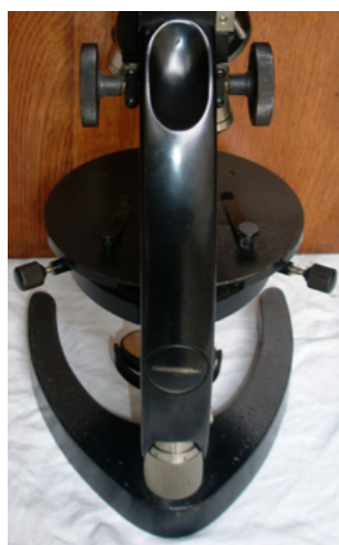
Fig. 10. Microscope Koristka. Mise au point fine située au bas de la potence
