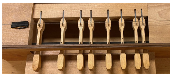
Fig. 2. Le monocorde de Pythagore de l'XP : la fondamentale est donnée par la première touche à gauche, l'octave par la huitième, la quinte par la cinquième, etc. © XP
