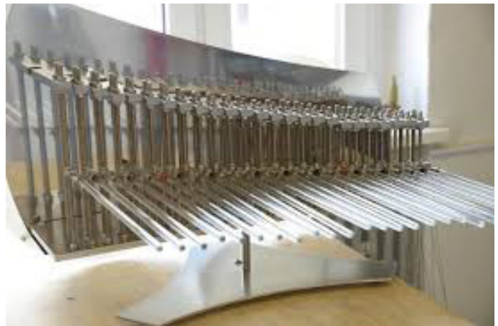
Fig. 7. Une version moderne de l'euphone. Les tiges en verre sont frottées et font résonner des tiges métalliques de tailles différentes, créant un son qui résonne ensuite dans les plaques métalliques.
