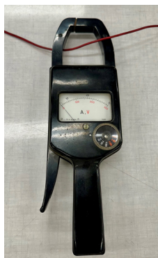
Fig. 4. Pince ampèremétrique à effet hall Système de mesure non invasif © BEAMS
