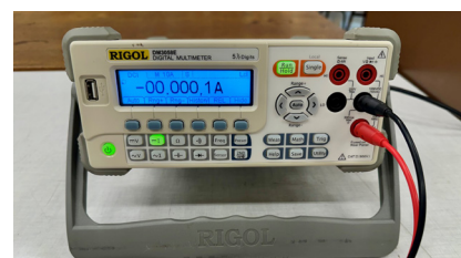
Fig. 3. Ampèremètre numérique intégrant shunt et millivoltmètre dans un seul boîtier © BEAMS
